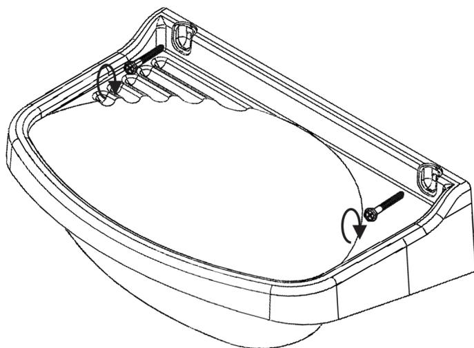
4 - Colocar las tapas cubre tornillos para finalizar la instalación.
