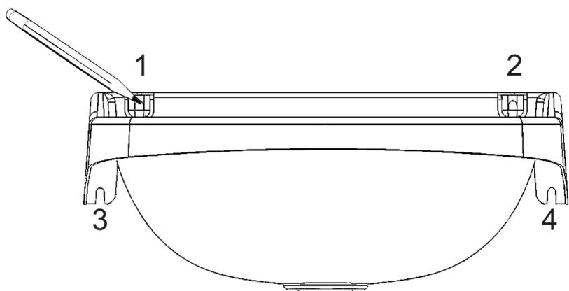
2 -Realizar las perforaciones para cuatro tarugos plásticos de 6 mm de diámetro.
