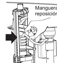
NOTA: En caso de tratarse de una válvula con reposición, colocar la manguera en la descarga como indica la figura.
